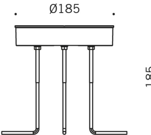
**S.5699****ANCHOR FLANGE TO BE CEMENTED TO THE GROUND**
