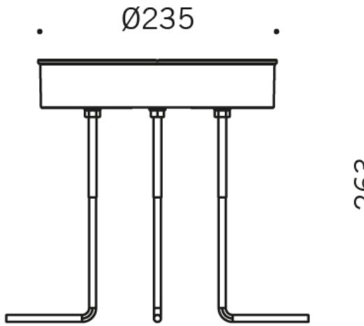
**S.5690****ANCHOR FLANGE TO BE CEMENTED TO THE GROUND**
