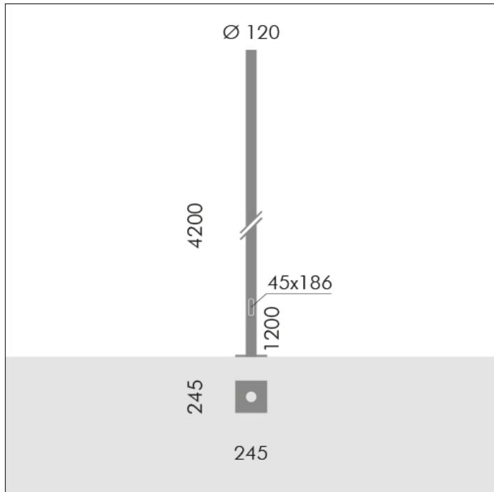
**S.2846****PALO CILINDRICO H 4,2m f.t., Ø120mm FLANGIATO**
