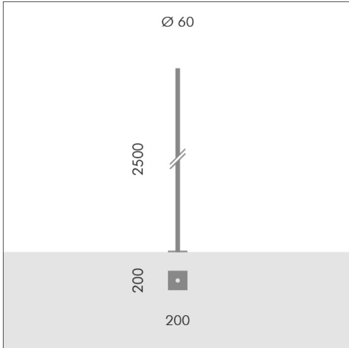
**S.2801****PALO CILINDRICO H 2,5m f.t., Ø60mm FLANGIATO**
